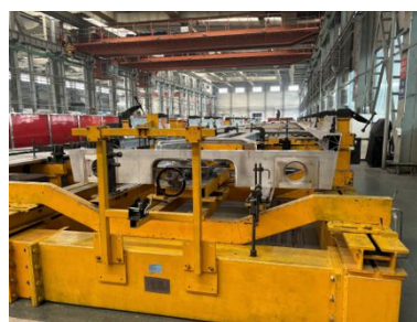
图7 底架组焊过程
